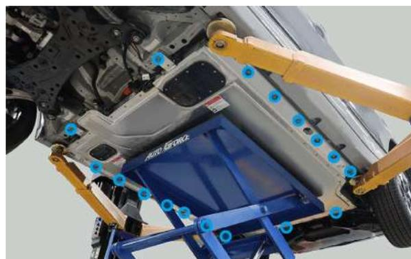
7. 高電圧バッテリーシステムアセンブリを車両から取り外す。
