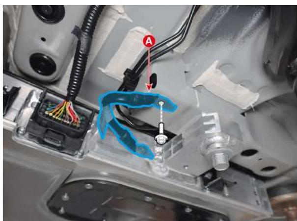
4. 高電圧バッテリーシステムアセンブリの中央部の固定ボルト(A)を緩める。
