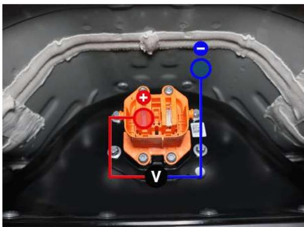
(4) 高電圧バッテリー (-) 端子とグラウンド間の電圧を測定します。
