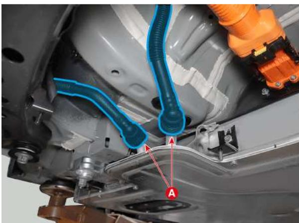
5. 各接続部より圧縮空気を送り、バッテリー内のクーラントを排出する。
