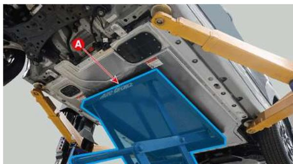
6. 高電圧バッテリーシステムアセンブリのサイド固定ボルトを緩める。
