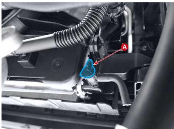
4. 冷却水のインレットホースおよびアウトレットホース (A) を分離する。
