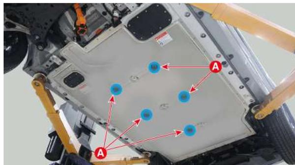
5. 高電圧バッテリーパックアセンブリをフロアジャッキで支持する。
